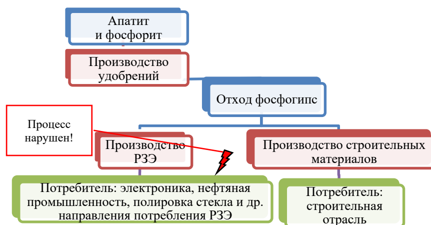
Рис. 7. Процесс комплексной переработки по схеме «Апатит, фосфорит – фосфогипс – РЗЭ, строительные материалы» (составлено авторами)
